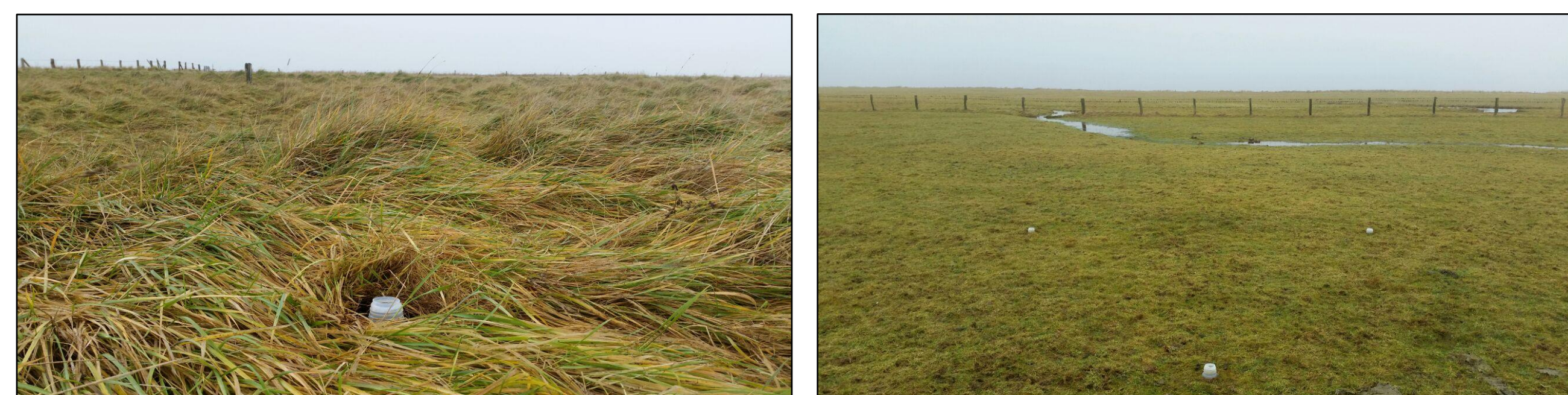
Sedimentationsmessungen auf Hallig Langeneß: Sedimentfallen auf Brachfläche (links) und Weidefläche (rechts)
